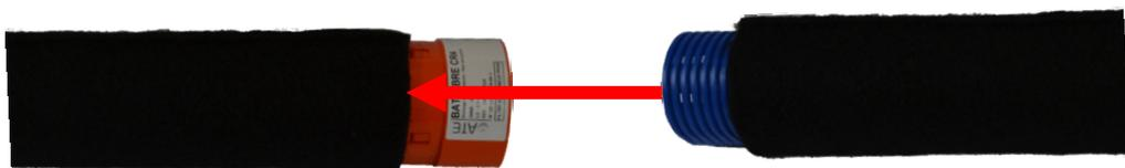
**FIGURA N°16: CONEXIÓN DE DOS DRENAJES ENCAJÁNDOLOS**
