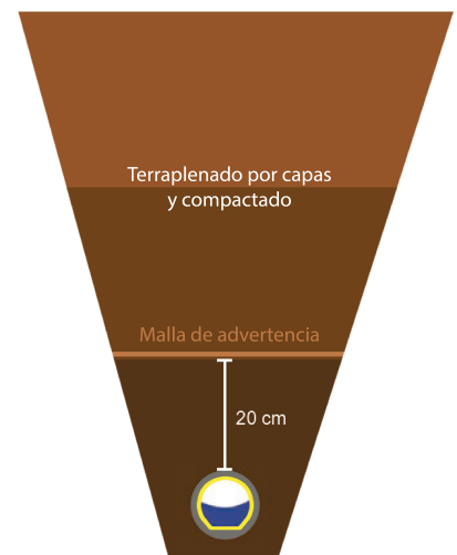
FIGURA n°28: CORTE DE PRINCIPIO PARA LA INDICACIÓN DE LAS REDES
