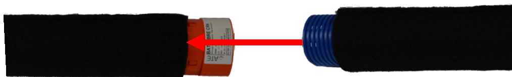
FIGURE N°16 : RACCORDEMENT DE DEUX DRAINS PAR EMBOÏEMENT
